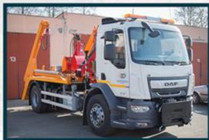
pojazd z zabudową bramową i żurawiem (wywóz kontenerów oraz opróżniania pojemników na odpady segregowane)
