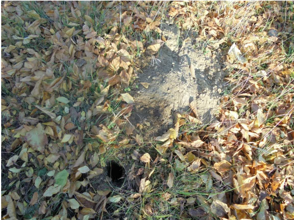
Odwiert nr 1 30cm nasyp budowlany/ziemia, 120cm grunty piaszczyste
