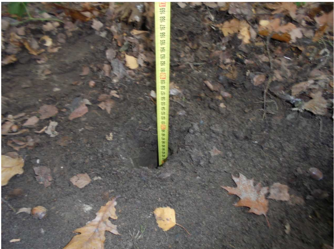
Odwiert nr 5 40cm nasyp budowlany, 110cm piasek
