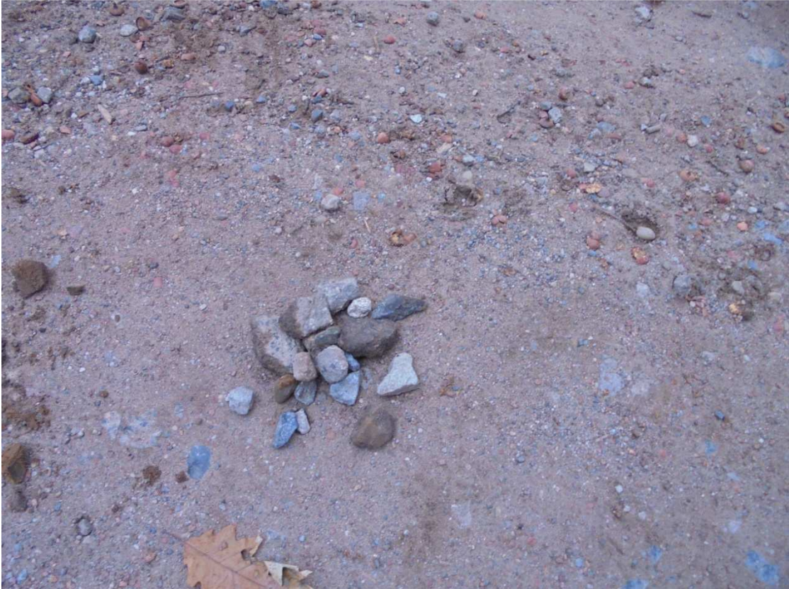
Odwiert nr 2 8cm asfalt, tłuczeń, piasek
