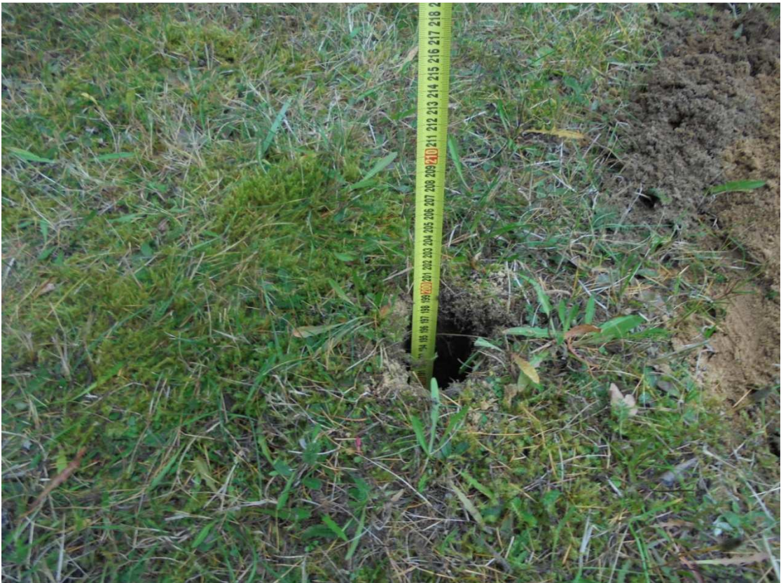
Odwiert nr 7 10cm darnina, 30cm nasyp z gruntu organicznego, 160 cm piasek
