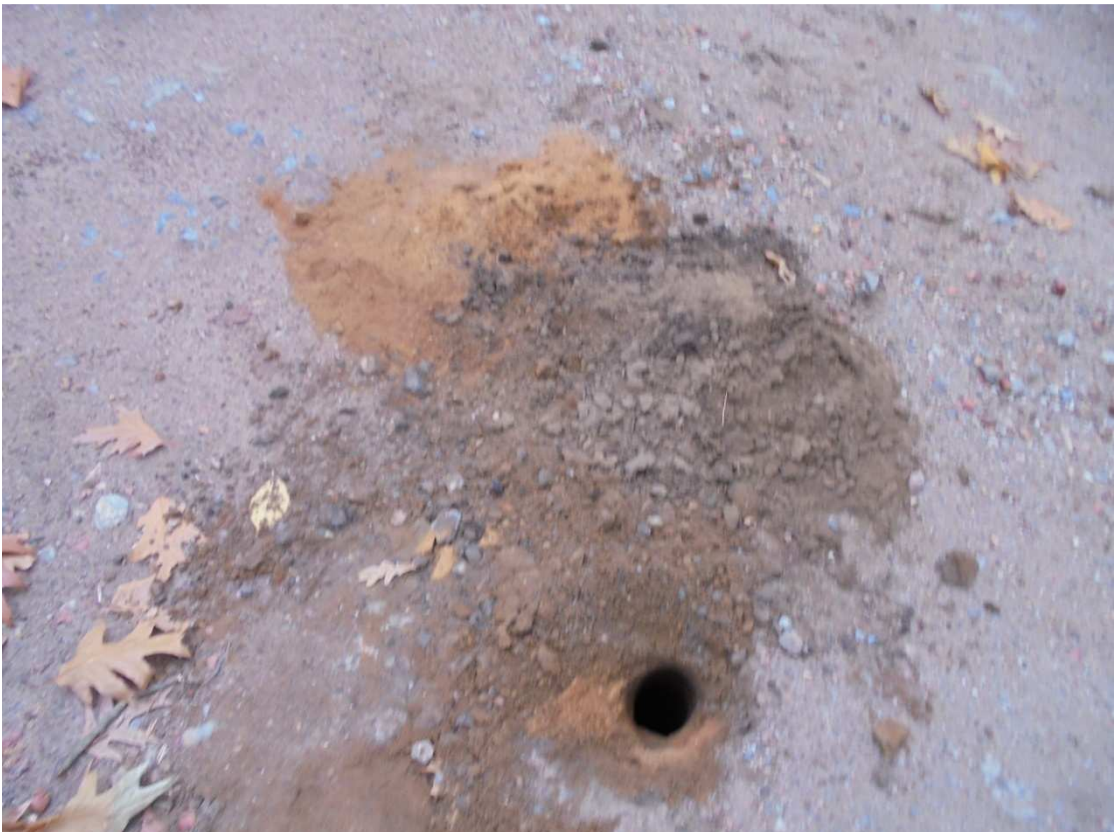
Odwiert nr 3 90cm nasyp budowlany/ziemia, 80cm piasek
