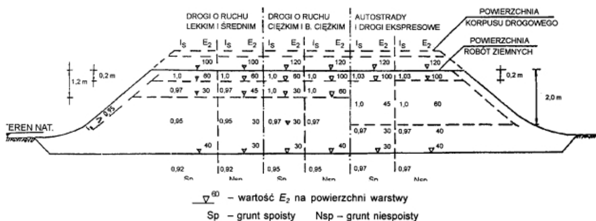
Rys. 1. Wartości wymagane w nasypach: wskaźnika zagęszczenia I_s i wtórnego modułu odkształcenia E_2 , w [MPa], wg [1].
