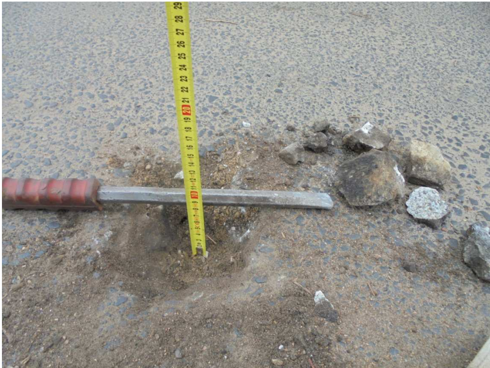
Odwiert nr 3 - ul. Wojciecha Korfańtego 3cm nawierzchnia bitumiczna, 8cm kostka, grunty piaszczyste z lokalnymi przewarstwieniami pasków pylastych
