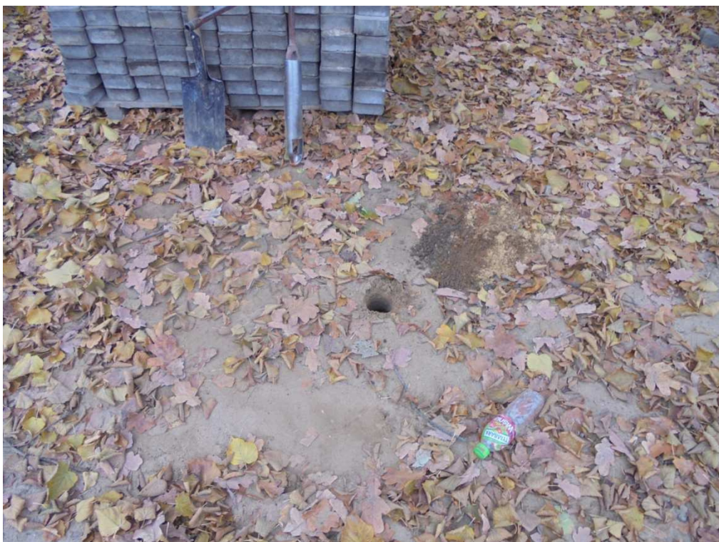
Odwiert nr 4 - skwer przed zatoką postojową na ul. Korfańtego 20cm nasyp niebudowlany, grunty piaszczyste z lokalnymi przewarstwieniami pasków pylastych
