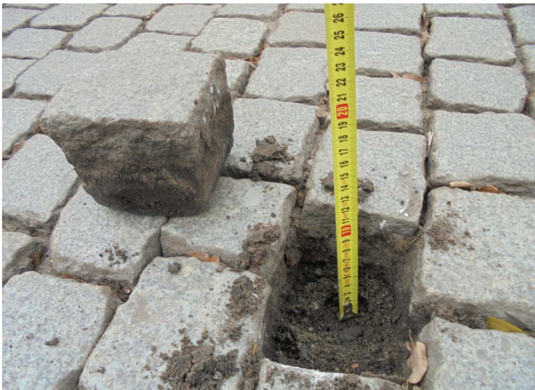
Odwiert nr 2 - DW Nr 448 przed kapliczką 10x10cm kostka kamienna, żwir, piasek, kamienie, grunty piaszczyste z lokalnymi przewarstwieniami pasków pylastych
