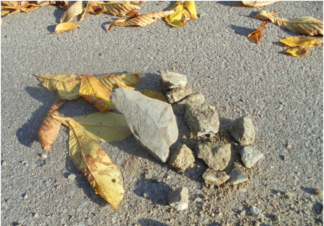
4cm nawierzchnia bitumiczna, 11cm tłućzeń kamienny
